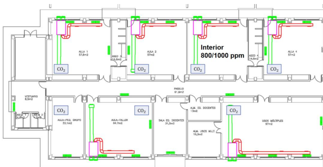
Figura 7. Instalación mecánica de ventilación y recuperador de calor en centros con ventilación natural (Se garantizará una distancia mínima entre las tomas de aspiración y extracción).
