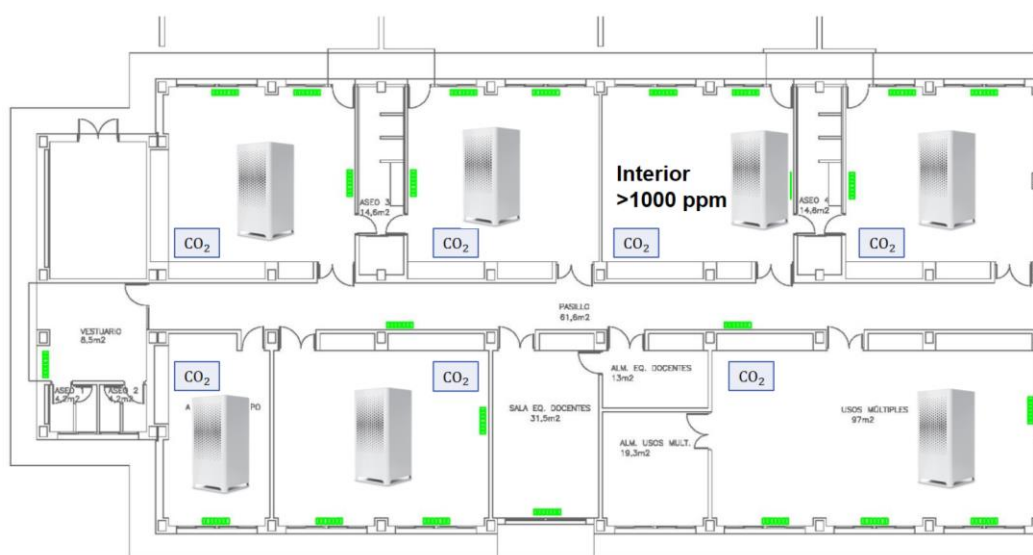
Figura 9. Colocación de purificadores en las aulas.
