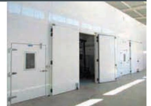
de -22 a 54°C y agua de 5 a 65°C. Humedad relativa de 25 a 90% HR y caudal 50 kW, AIRE 1,3 a 20.000m<sup>3</sup>/h y 100 kW, AIRE 1,3 a 40.000m<sup>3</sup>/h. Agua 14 a 700 kg/min con una potencia máxima de 100 kW y alimentación eléctrica con una tensión de 166 a 480V, 1Ø & 3Ø y Frecuencia de red 50 & 60 Hz
